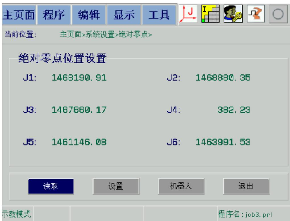
图 6-1 绝对零点校准界面
